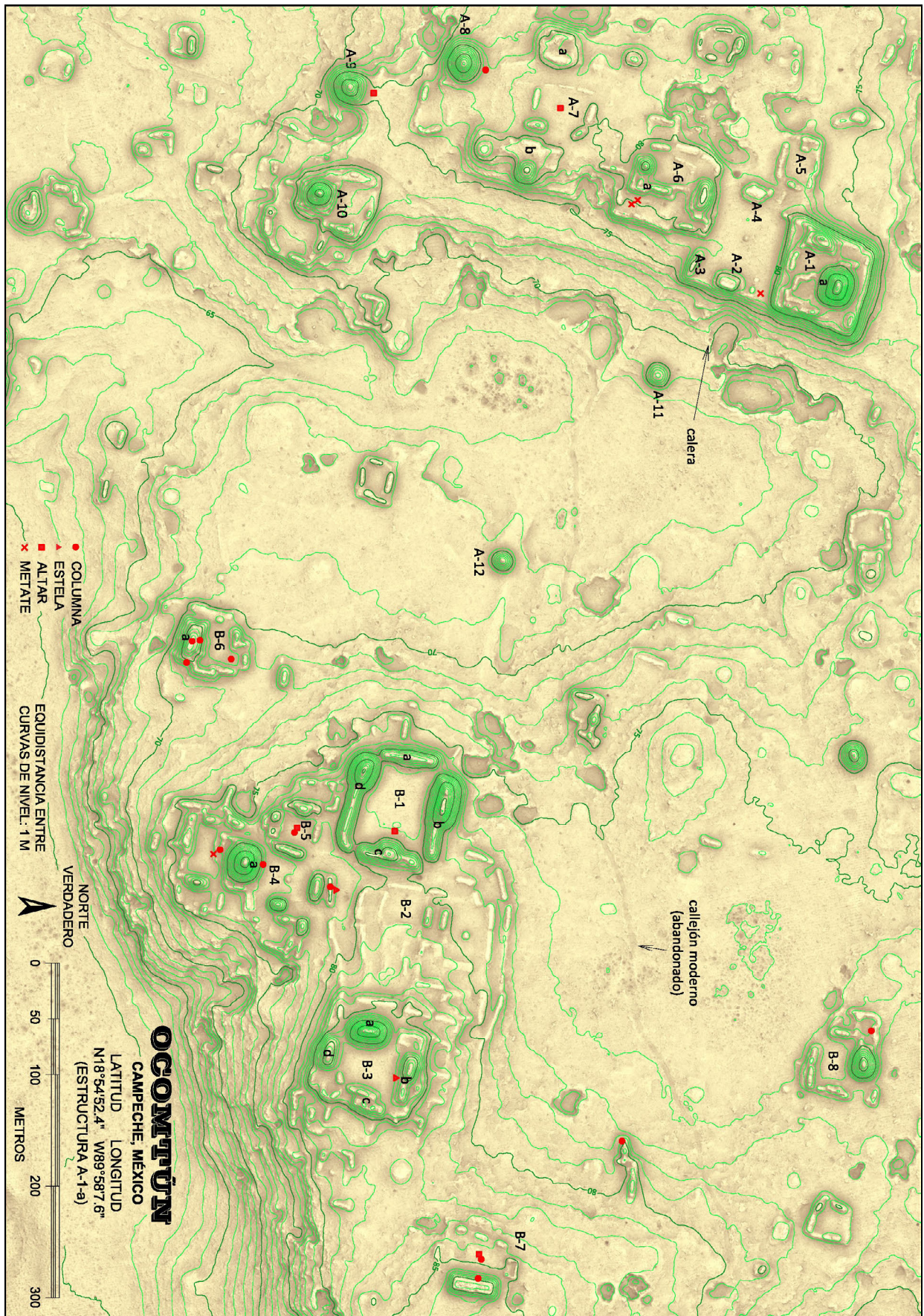
Figura 3.39. Ocomtún, plano del núcleo monumental (las alturas de las curvas de nivel, elaboradas a partir del modelo digital derivado de los datos LiDAR, son sobre el elipsoide WGS84).
