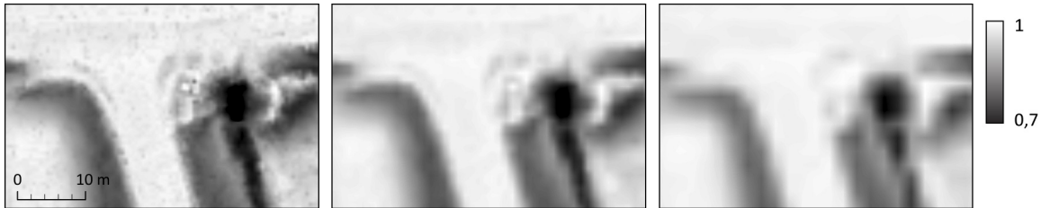
Slika 26: Primerjava podob deleža vidnega neba izračunanega na razdalji 5 m v 32 smereh iz modelov reliefa različne ločljivosti: od leve proti desni 0,5 m, 1, m in 2m.
