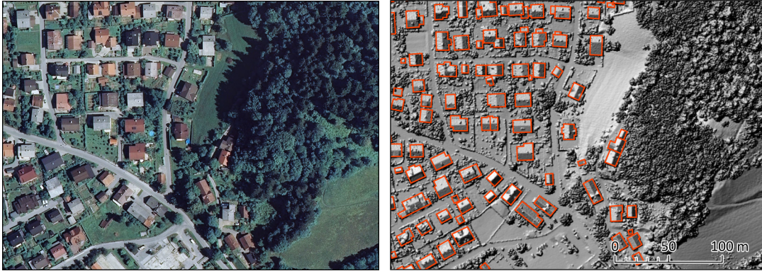
Slika 12: Letalski ortofoto posnetek v ločljivosti 0,25 m (levo, GURS) in senčen model površja rastriranega oblaka vseh laserskih točk (največja višina v celici) s popravljenimi obodi stavb (desno), ki prikazujeta del območja na katerem sem preizkušal algoritme filtriranja.
